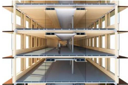
↑ Im Systemschnitt gut zu erkennen ist die unterschiedliche Feldgröße der Deckenelemente. Die Stahlträger sind aus der Mittelachse des Gebäudes herausgerückt.
