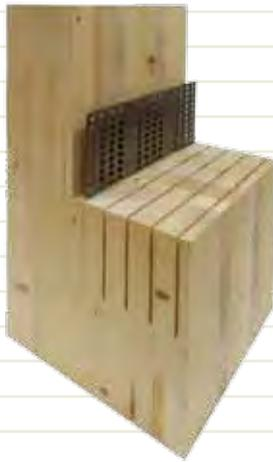
In Brettschichtholz eingeklebtes Lochblech
